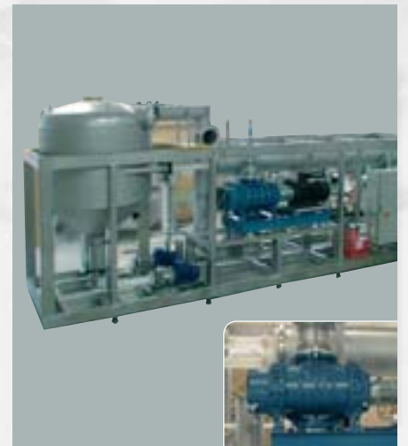
• Industria metalmecánica: tratamiento de las emulsiones aceitosas y de los líquidos de lavado mediante instalación de concentración por termocompresión. Soplante de lóbulos ( RBS )
